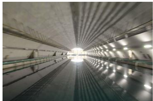
世界最大級の400m曳航水槽 (長さ400m、幅18m、水深8m)
